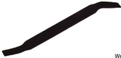
Brake shoe adjuster tool เครื่องมือปรับตั้งคริมเบรค
