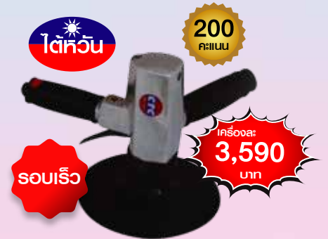
เครื่องขัดสีระบบลม 7" ความเร็วรอบ 4,000 R.P.M.
